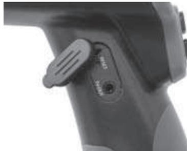
Рис. 9 - Гнездо выхода телевизионного сигнала TV-OUT/Кнопка сброса "Reset"
